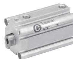
Grazie alla doppia guarnizione di tenuta dello stelo e la presenza di uno sfianto per lo scarico diretto all'esterno della camera bianca, questo attuatore risulta adatto per usi in ambienti sterili Classe 100.
