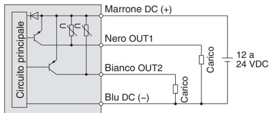
Max. corrente di carico: 80 mA, caduta di tensione interna: 1.5 V max.
